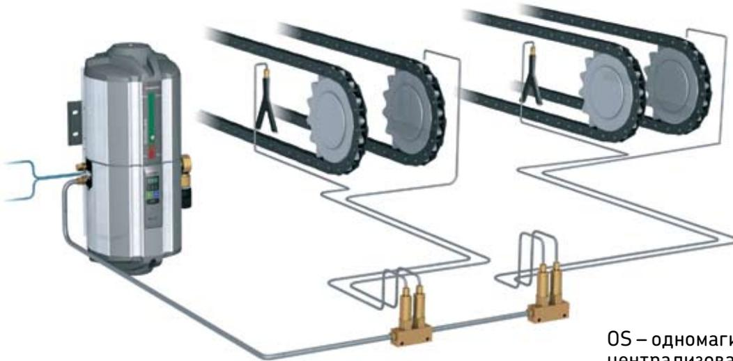
**OS – одномагистральная централизованная система смазки**
