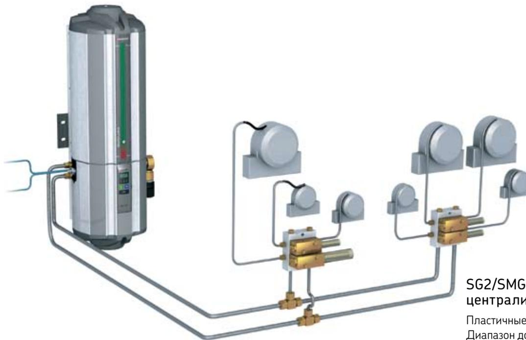
**SG2/SMG - двухмагистральная централизованная система смазки**
